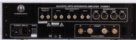
POWER Iの背面部。アナログ入力はRCA×3とXLR×2を装備する。スピーカー出力端子は1系統
